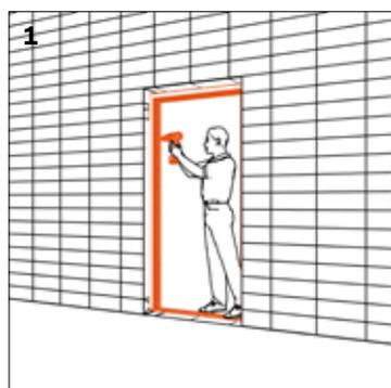
1 Fijación del nuevo marco al muro en fase de obra.
