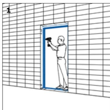
1 Fijación del premarco aislante térmico al muro en fase de obra.
