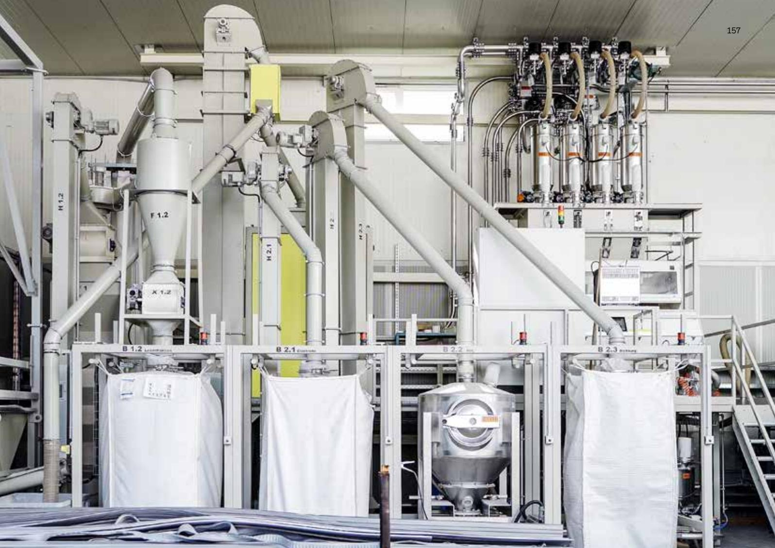
↑ La moderna planta de reciclaje permite reutilizar internamente los descartes y recortes de los perfiles de PVC.
